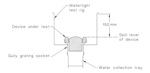
FIGURE B1 TYPICAL INFILTRATION TEST SET-UP
